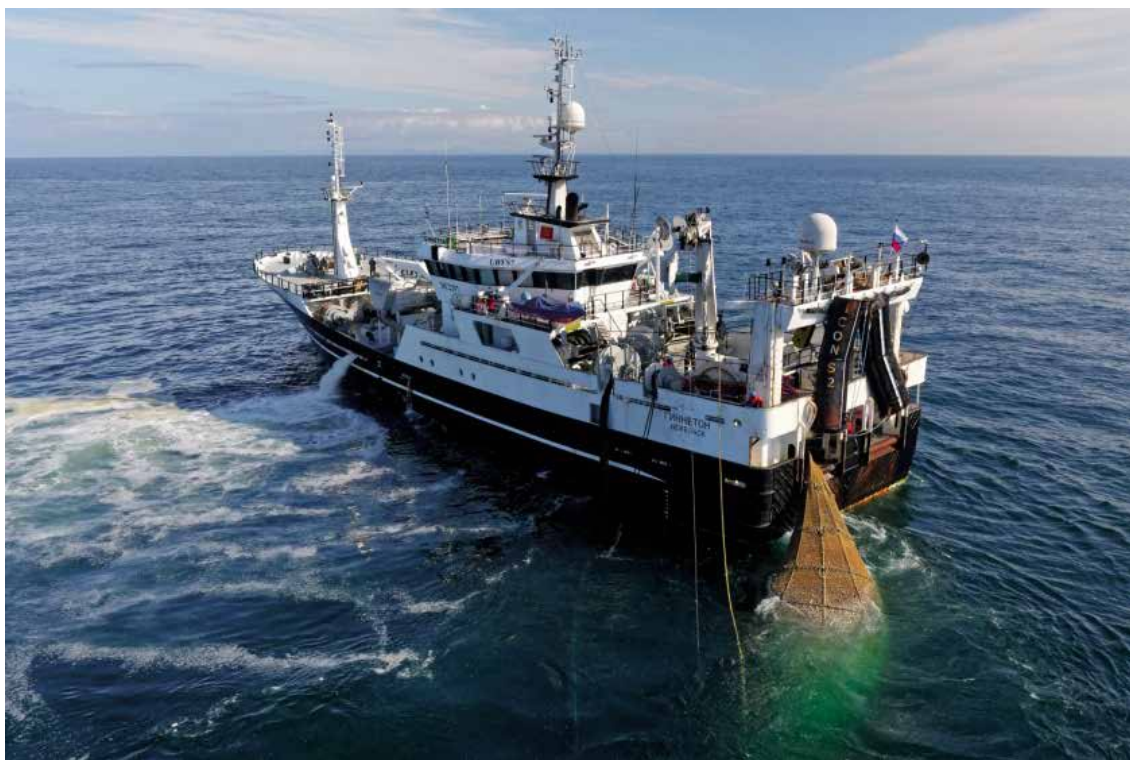
Рисунок 3. Перекачка улова из тралового мешка в охлаждаемые трюма на наливном судне. Фото Л.В. Шапки
