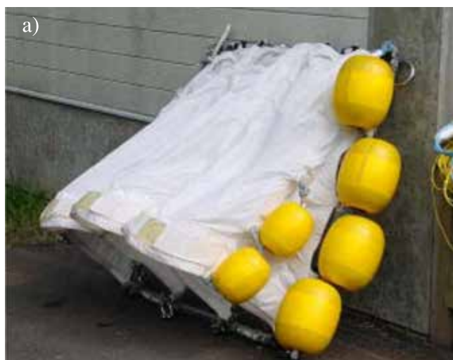
Рисунок 3. Промысловая работа боковой траловой системы [2; 3] а – гибкий распорный щиток; б – буксировка трала с ГРУ Figure 3. Fishing operation of the side trawl system [2; 3] a – flexible spacer shield; b – towing of the trawl from the GRU
