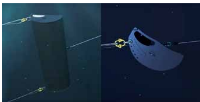
Рисунок 8. Смещение крепежа кабеля назад Figure 8. Cable fastener offset backwards
