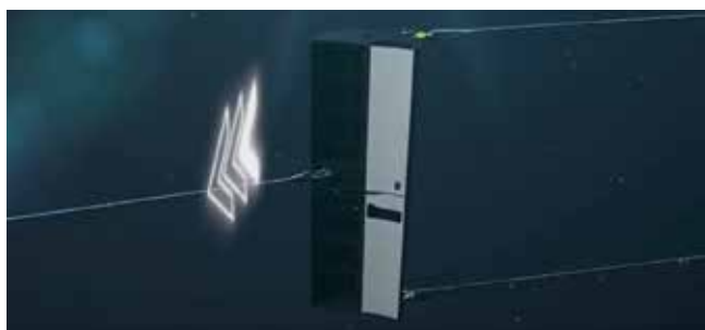
Рисунок 14. Смещение крепежа ваера вверх
