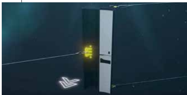
Рисунок 12. Смещение ваерной планки вперёд
