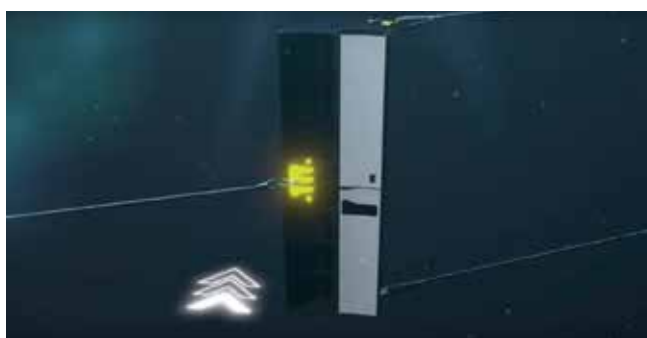
Рисунок 13. Смещение ваерной планки назад
