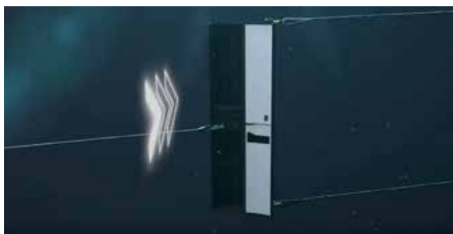
Рисунок 15. Смещение крепежа ваера вниз
