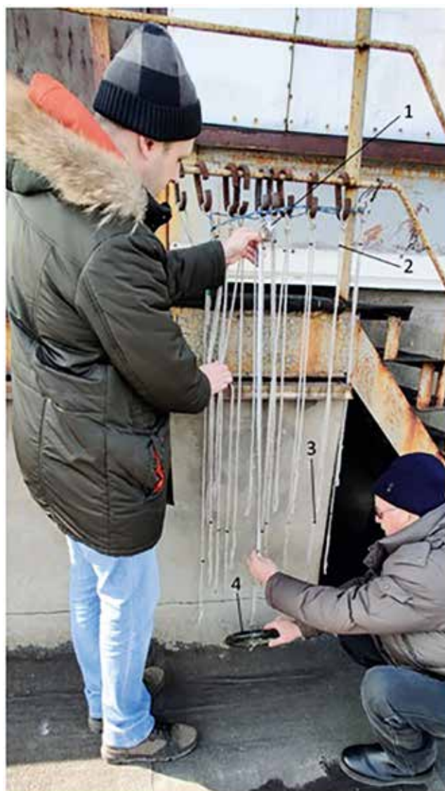
Рисунок 4. Измерение длины образцов канатов, где: 1 – рулетка; 2 – верхняя марка; 3 – нижняя марка; 4 – груз массой 5 кг
