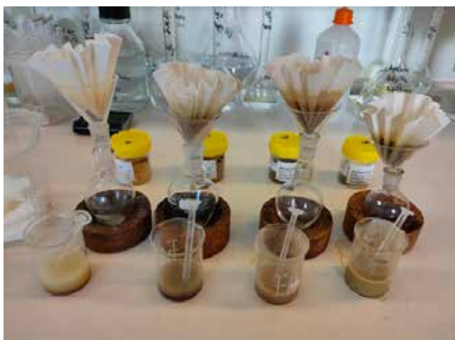
Рисунок 2. Анализ содержания жира в образцах биодобавок
