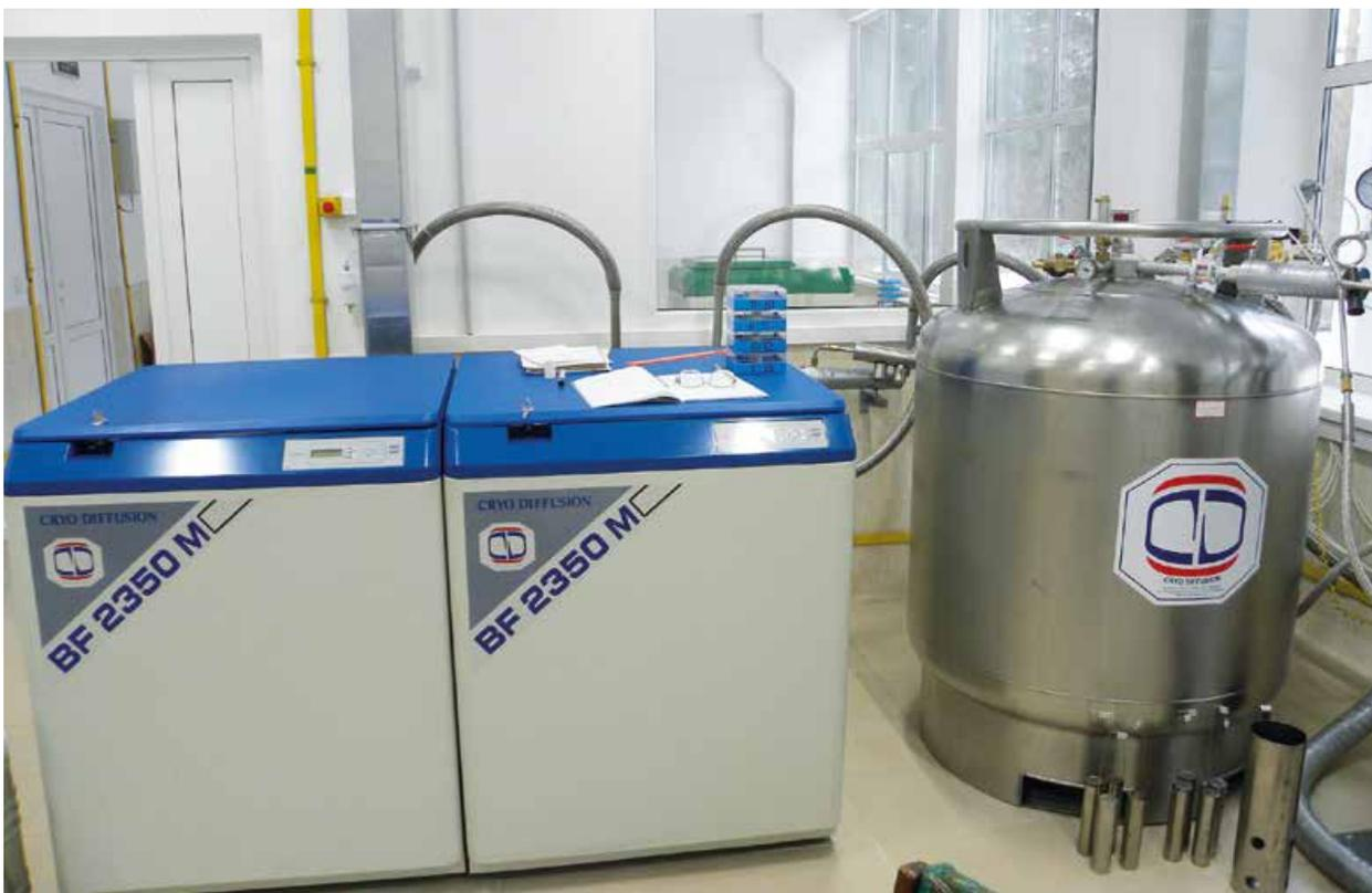
Криохранилища и резервная емкость с жидким азотом в криобанке ВНИИПРХ / Cryostorages and reserve capacity with liquid nitrogen in the cryobank of VNIIPRKh
