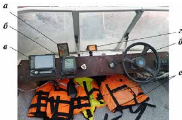
Рисунок 6. Устройство приборной панели: а – метеостанция; б – эхолот; в – поисковый планшет; г – сигнатурное комбо устройство; д – компас; е – спасательные жилеты
