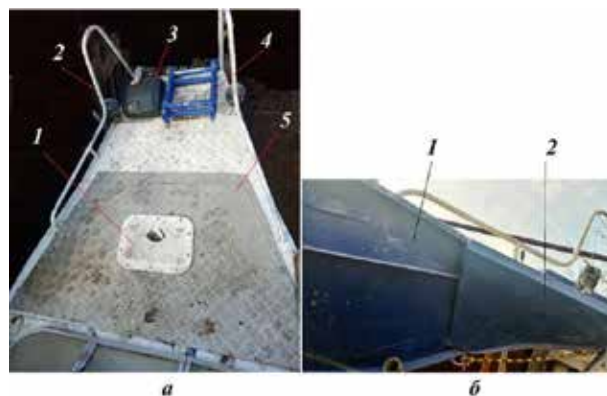
Рисунок 1. Внешний вид палубы плавучей лаборатории: а – устройство палубы, общий вид (1 – люк; 2 – леер; 3 – лебедка; 4 – трап; 5 – палуба); б – крепление палубы к корпусу (1 – основной корпус; 2 – конструкция для увеличения палубы)
