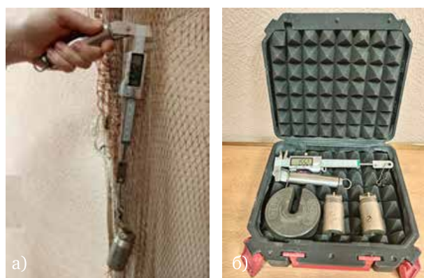
Рисунок 5. Прибор собственной разработки: А – процесс измерения внутреннего размера ячеи. Б – общий вид прибора с набором грузов в кейс-контейнере
