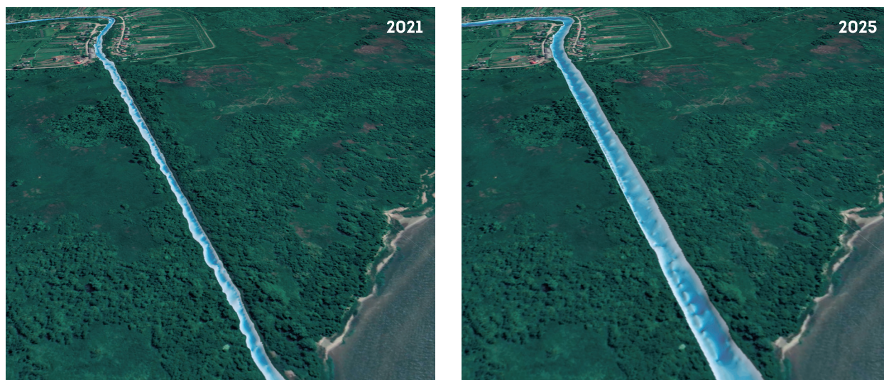
Рисунок 2. 3D-визуализация рельефа дна участка р. Промысловая (от устья до поселка Причалы) до (2021 г.) и после (2025 г.) проведения мелиоративных работ
