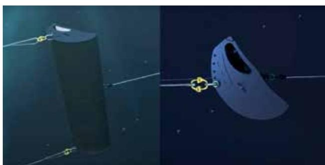
**Рисунок 7.** Смещение крепежа кабеля вперед
