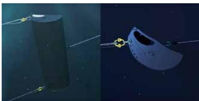
**Рисунок 8.** Смещение крепежа кабеля назад
