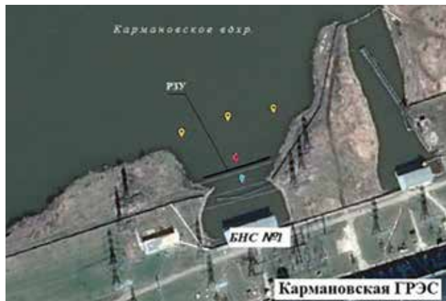
Рисунок 4. Карта-схема расположения Кармановской ГРЭС с обозначением станций отбора проб: желтый пунсон – водохранилище (ст.1, 2, 3а); красный пунсон – перед РЗУ (ст.3); голубой пунсон – после РЗУ (ст. 4, 5, между РЗУ и боами)
