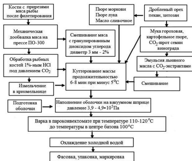
**Рисунок 1.** Структурная схема производства рыборастворительных паштетов
