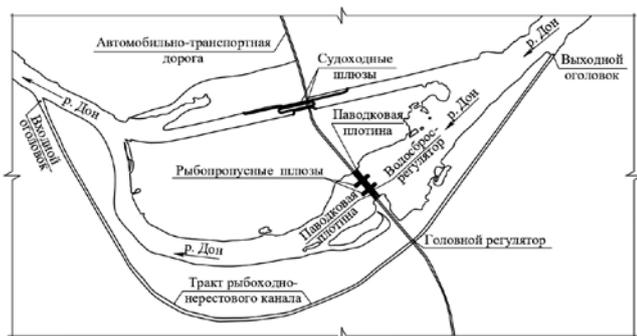
**Рисунок 2.** План-схема Константиновского гидроузла на реке Дон
