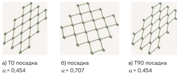
**Рисунок 4.** Участок узловой дели  $d/a=0,08$
