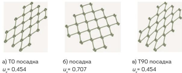
**Рисунок 3.** Участок узловой дели  $d/a=0,1$
