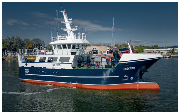
Рисунок 1. Малый сейнер-траулер проекта 174610 «Всеслав», спущенный на воду в 2023 г. в г. Светлом Калининградской области, направляется на промысел
