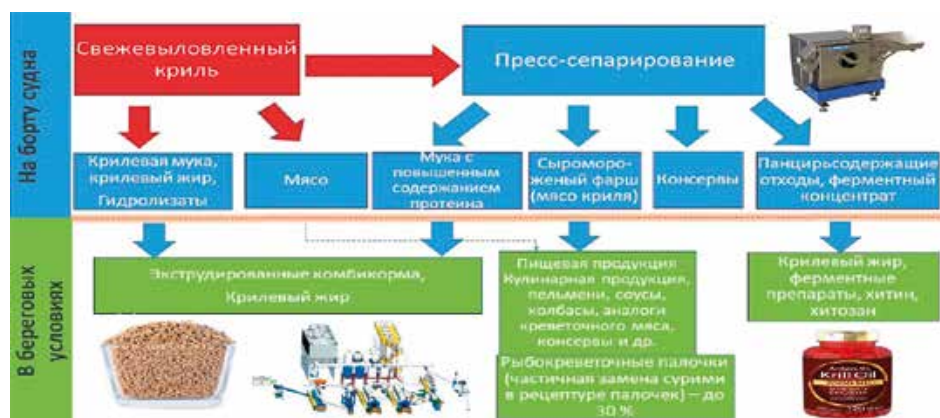
Рисунок 8. Дифференци- рованная концепция переработки антарктического криля
