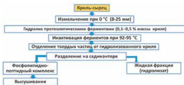
Рисунок 7. Технологическая схема получения продукции из антарктического криля с пониженным содержанием фтора
