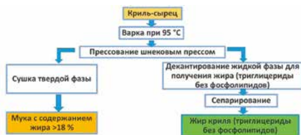
Рисунок 5. Прессово-сушильная схема производства крилевого муки и жира
