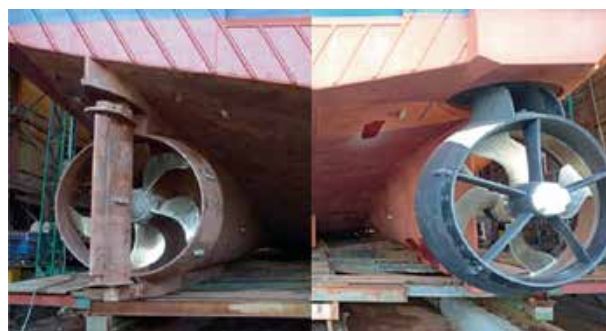
Рисунок 8. Совмещенные фотографии кормовой части НИС «Gunnerus» в доке до (слева) и после (справа) окончания работ по замене старой винто-рулевой группы на ВРК
