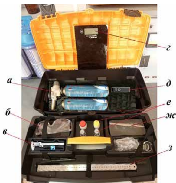
Рисунок 7. Кейс-контейнер ихтиологических работ: а – газовая горелка; б – защитные очки; в – штангенциркуль; г – электронные весы; д – термометр электронный; е – посуда для отбора проб; ж – скальпель; з – линейка
