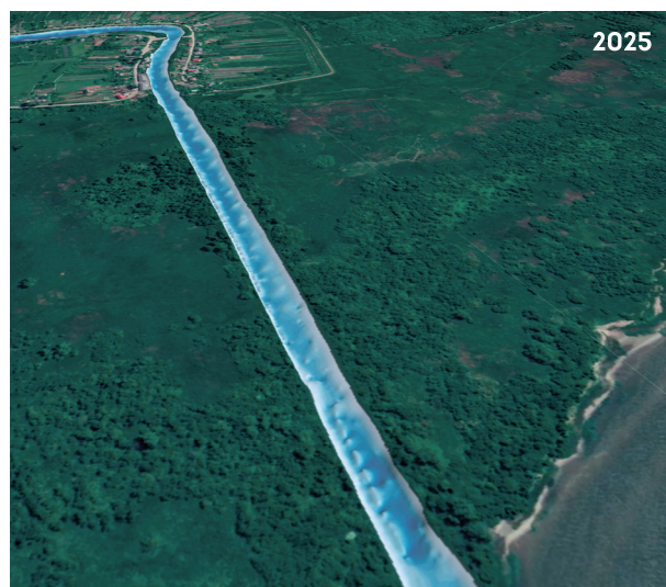
Рисунок 2. 3D-визуализация рельефа дна участка р. Промысловая (от устья до поселка Причалы) до (2021 г.) и после (2025 г.) проведения мелиоративных работ
