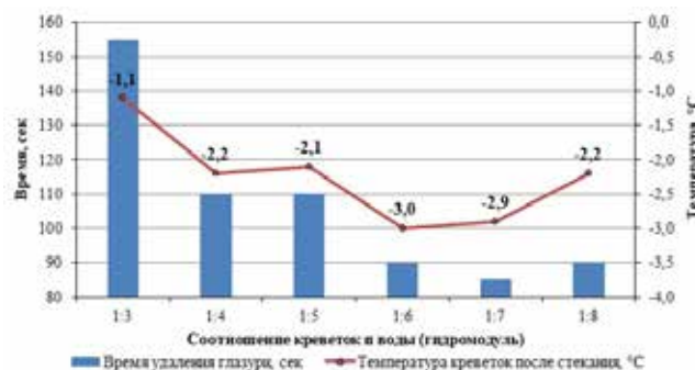
Рисунок 5. Время удаления глазури и средняя температура креветок после стекания в течение 2 минут при различном соотношении мороженой продукции и воды Figure 5. Glaze removal time and average temperature of shrimp after dripping for 2 minutes at various ratios of frozen products and water
