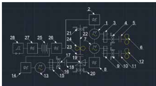
Рисунок 6. Схема активной пропульсивной системы тралового комплекса Figure 6. Diagram of the active propulsive system of the trawl complex
