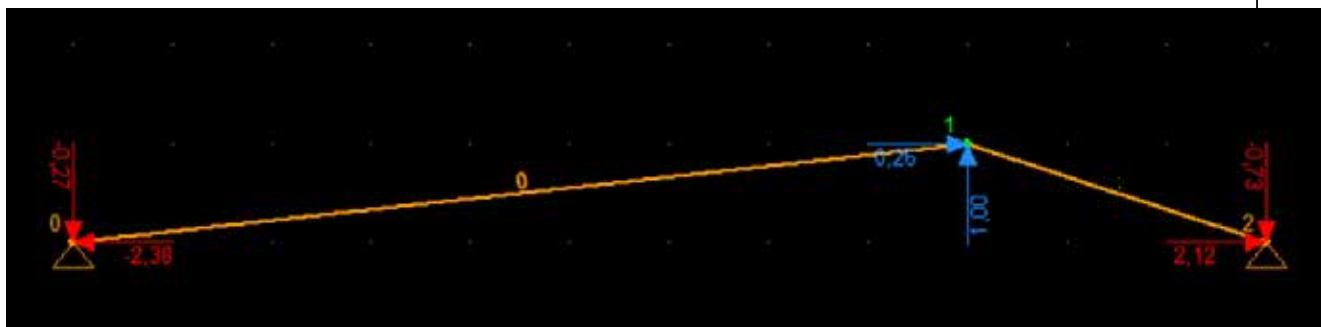
Рисунок 2. Нагружение траловой системы при единичной распорной силе Figure 2. Loading of the trawl system at a single spacer force
