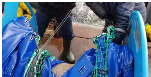
Рисунок 2. Наматывание ГРУ на кабельно-сетной барабан
