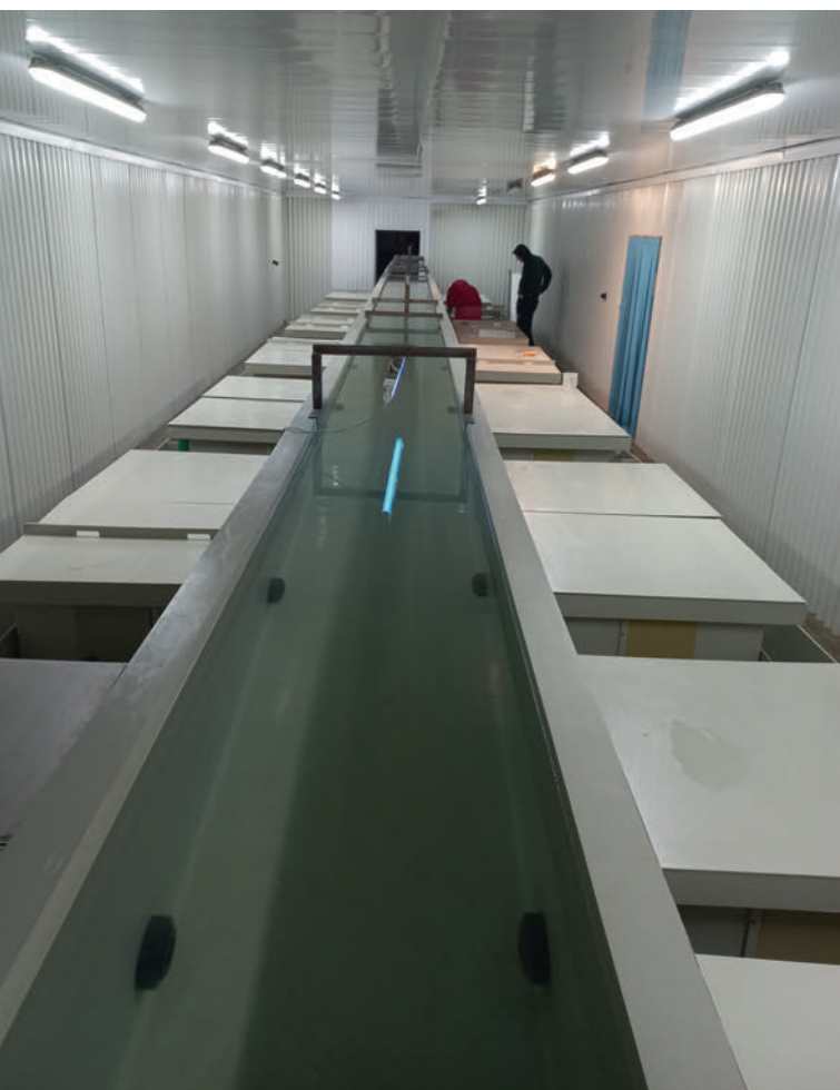
Инкубационный цех с аппаратами гравийного (флотационного) типа (фото А.А. Оглы)
