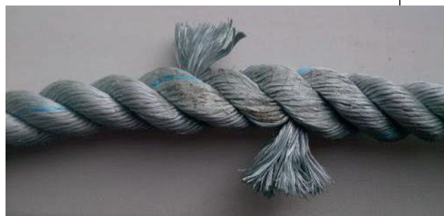
Рисунок 3. Частичный разрыв пряди при сжатии хребтины
