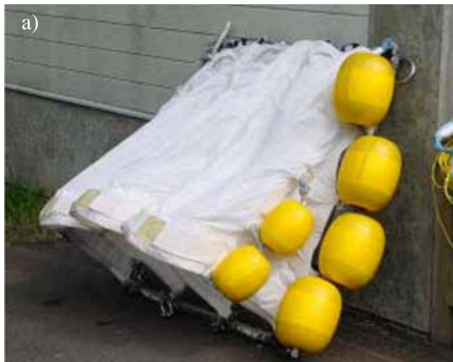
Рисунок 3. Промысловая работа боковой траловой системы [2; 3] а – гибкий распорный щиток; б – буксировка трала с ГРУ Figure 3. Fishing operation of the side trawl system [2; 3] a – flexible spacer shield; b – towing of the trawl from the GRU
