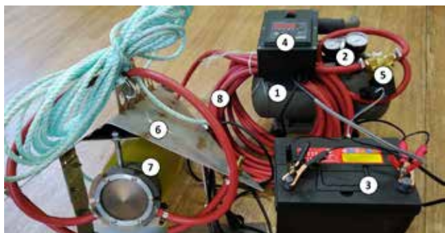
Рисунок 4. Макет буксируемого имитатора звуков косатки с системой дистанционного управления запуском (пояснения в тексте)
